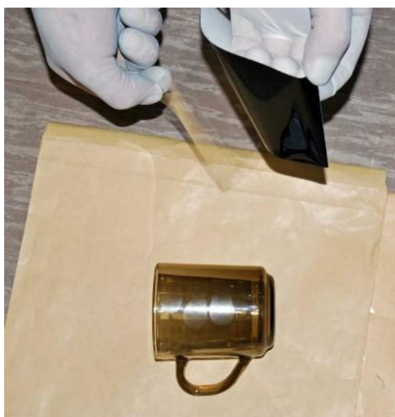
Zdejmowanie wierzchniej warstwy chroniącej klejącą powierzchnię folii
